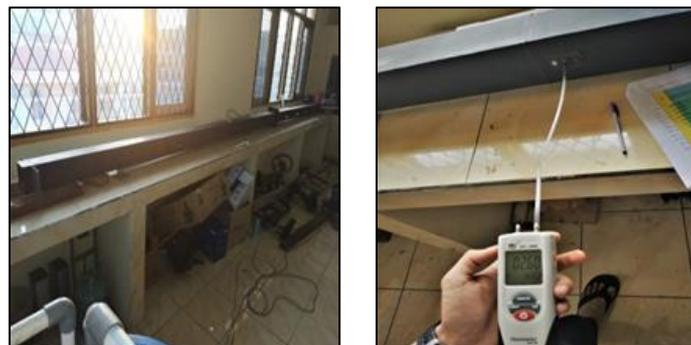
Gambar 2. Penampang saluran udara dengan penampang persegi panjang & HT-1890 Digital Manometer pengukuran tekanan pada tiap bagian titik tekan
